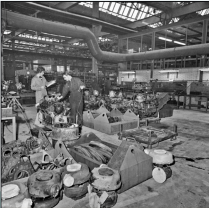
De sectie Motoren in 1978. Rechts in beeld SOFAM motoren van de AMX pantserrupsvoertuigen. Links op de foto, tussen de beide (rokende) monteurs in, een gedemonteerde M 109 Detroit Diesel motor. (NIMH)
