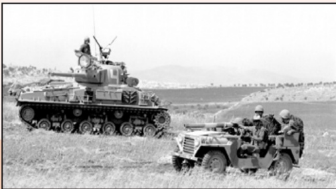
Een Israëlische M50 Super Sherman en een 4x4 Ford M151 MUTT met een 106 mm terugstootloze vuurmond. Beide vorm- den een grote bedreiging voor hun Syrische tegenstanders.
