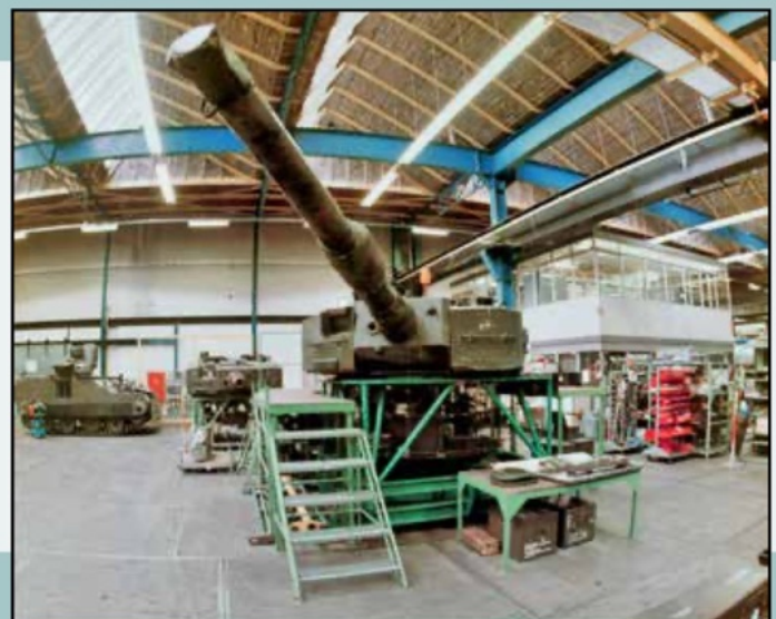
Nogmaals de sectie Koepel en Geschut ergens in de tweede helft van de jaren tachtig. Rechts twee torens van Leopard 2A4 tanks, links een M 113 C&V verkenningsvoertuig van de Cavalerie, reeds voorzien van een toren. (Afdeling Techniek)
