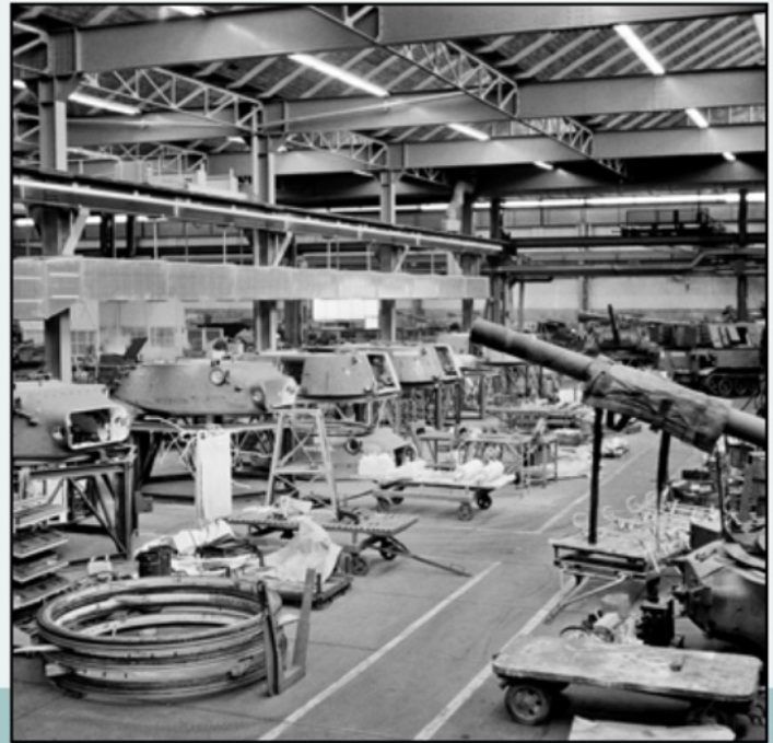
De sectie Koepel en Geschut op 28 april 1981. Links in beeld Leopard 1 torens met op de voorgrond een drietal torenlagers. (NIMH)
