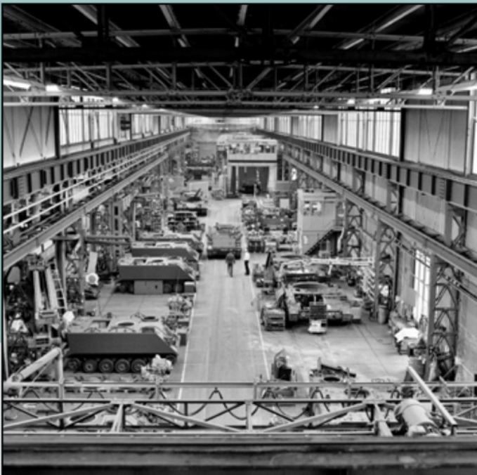
Overzichtsfoto genomen in juli 1989 van de oude montagelij (links) en oude demontagelij (rechts). Links op de foto M 113 voertuigen met daarachter Leopard 1V tanks. Rechts op de foto zijn twee M 109 houwitsers te zien.
